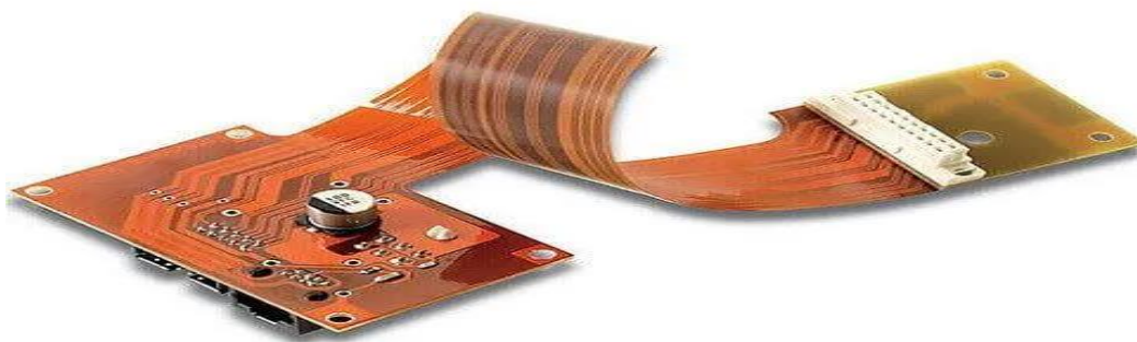
Figure 13.10 Actual Rigid Flexible PCB
